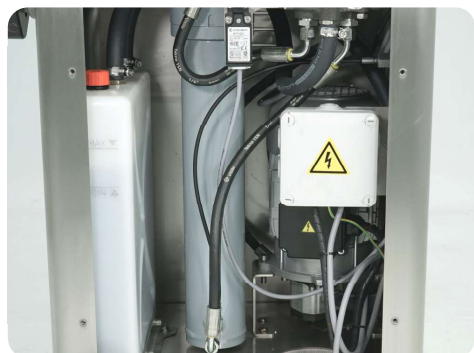
Groupe hydraulique puissant. Réservoir d'huile transparent indépendant.
