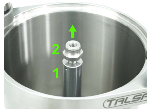
Vérin du cylindre hydraulique en acier inoxydable. Partie supérieure du vérin remplaçable.
