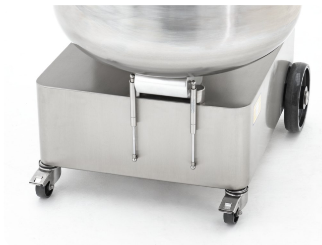
Cuve basculante avec amortisseurs pneumatiques pour MIX165.
