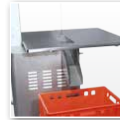
Schnittgutschacht Cutting good shaft
